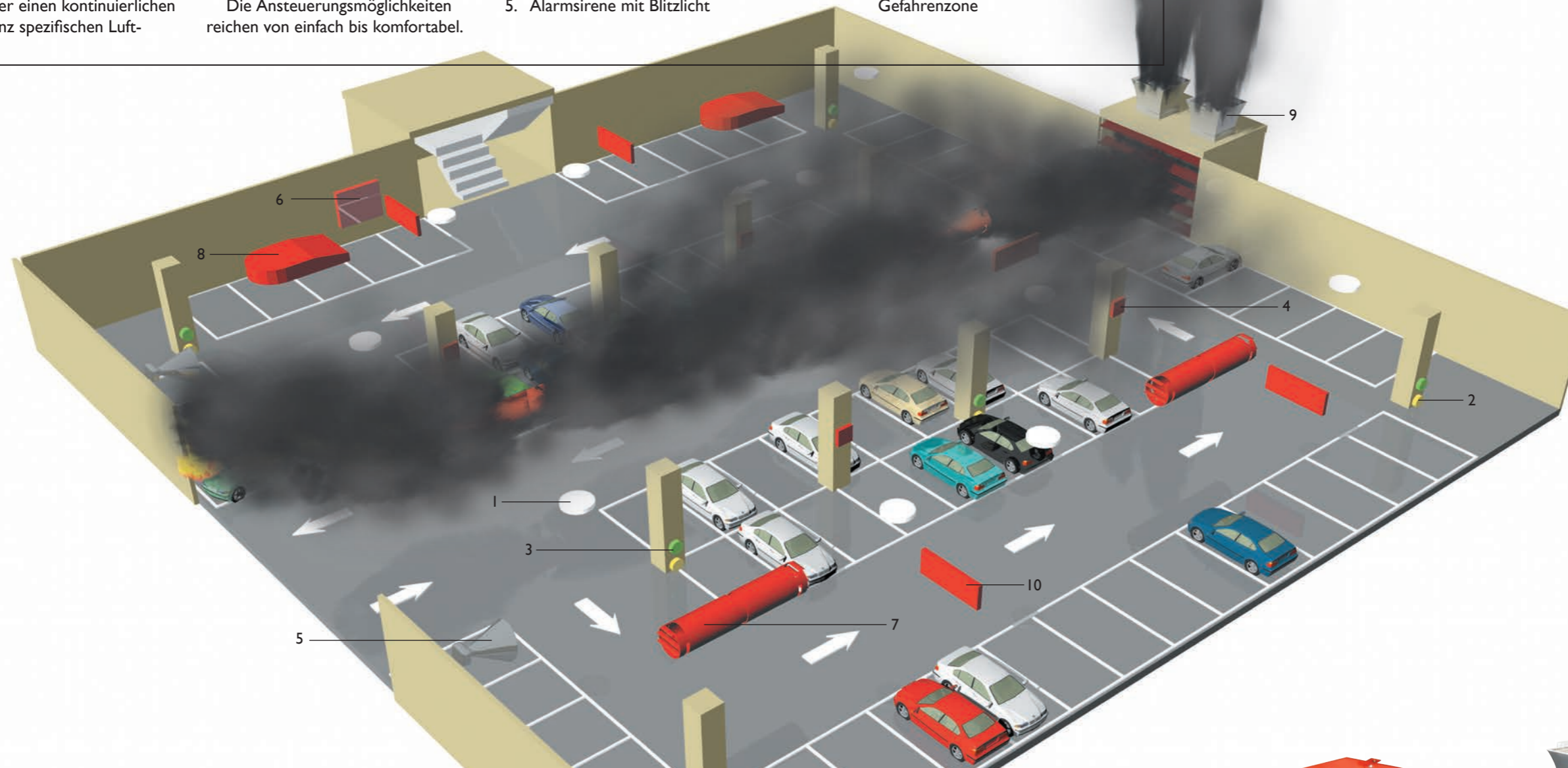
2/3. CO- und Flüssiggassensoren - Bei Überschreiten von frei wählbaren Grenzwerten werden die Systemkomponenten automatisch aktiviert und angesteuert.
